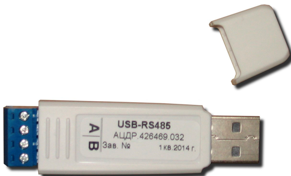
Рисунок И.3 – Преобразователь интерфейсов USB в RS-485 BOLID
