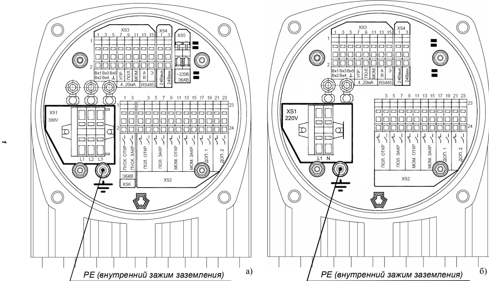
Рисунок 6 – Клеммный узел ВИМУ в металлическом корпусе для подключения силового кабеля и цепей удаленного управления со снятой крышкой: а – для подключения к трехфазной сети; б – для подключения к однофазной сети
