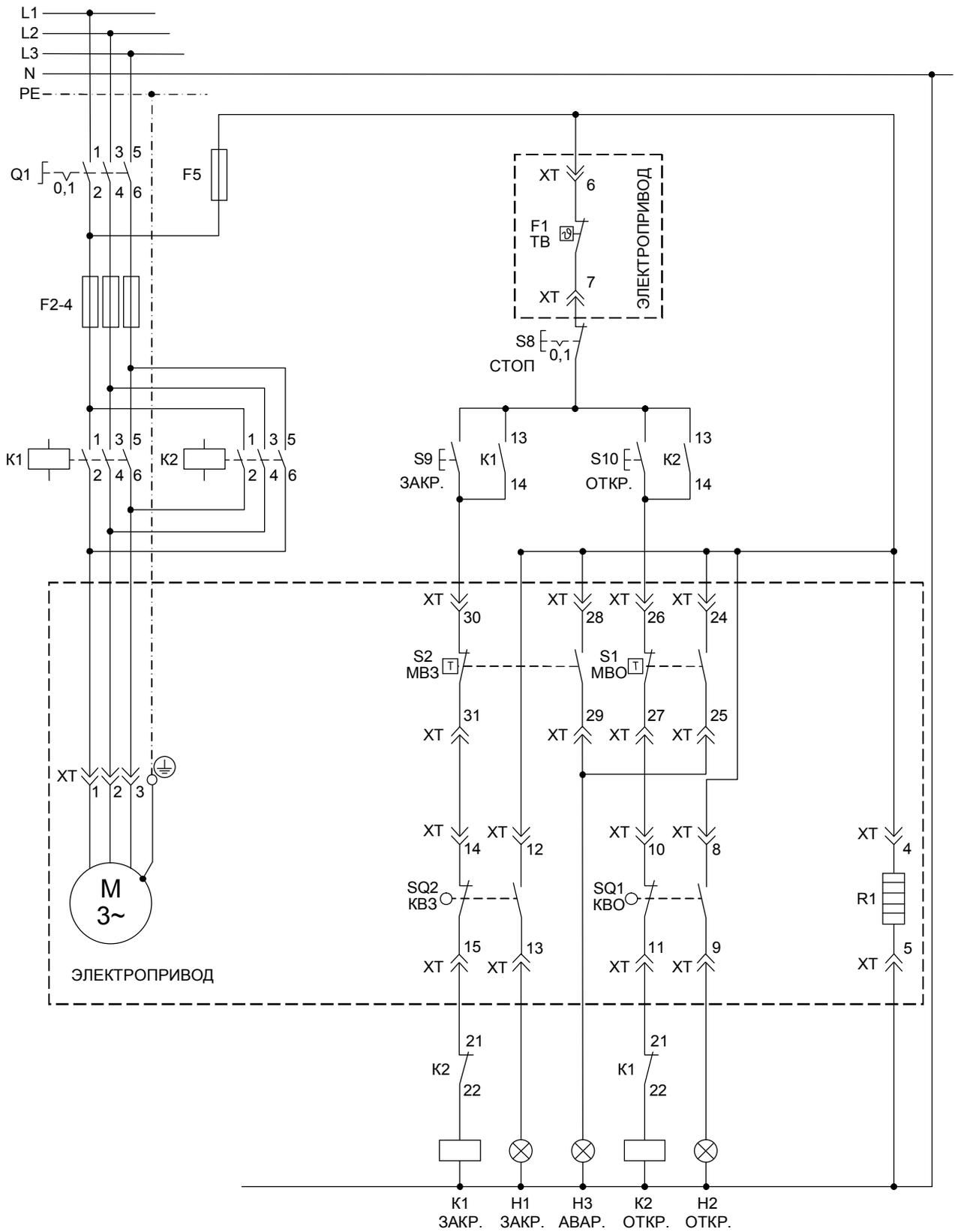
**Примерная электрическая схема подключения электроприводов ЭПН с механическим блоком концевых выключателей М20**
