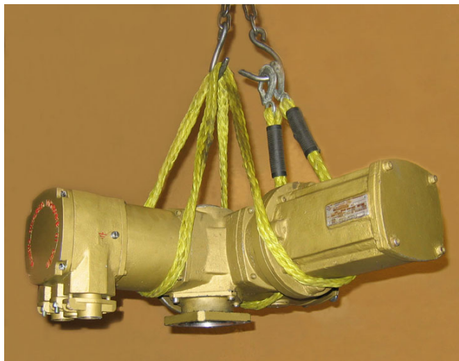
Рисунок 4 – Монтаж привода на арматуру
