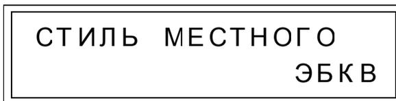
СТИЛЬ МЕСТНОГО – выбор разновидности режима местного управления приводом, содержит три значения – ЭБКВ, ЭИМУ и МБКВ:
