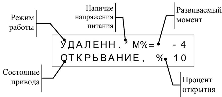
Рисунок 11 – Структура отображения информации на дисплее
